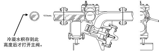
入口管的布置会影响到JH15的运行，入口管越长，每个周期排放的冷凝水量就会越多。这样在冷凝水量固定的情况下，主阀运行的周期就会变长，次数减少。减少磨损，延长使用寿命。而且由于冷凝水排放时会产生力，所以应尽可能的加长出口水平管道的长度，以降低冲击带来的振动。如果对布管有所疑问，请联系TLV。
